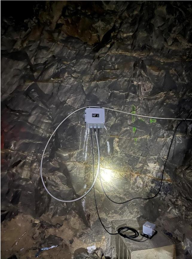
Sismomètre dans une mine
